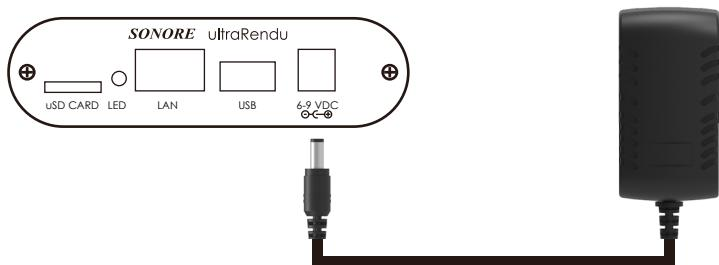
ultraRendu PlusのDC電源ジャックに付属ACアダプターのDCプラグを挿し込み、付属ACアダプターを壁コンセントや電源タップに接続ください。また、ultraRendu Plusは6V-9VDCに対応しているため、当電圧範囲内のDC電源をお使いいただくこともできます。
