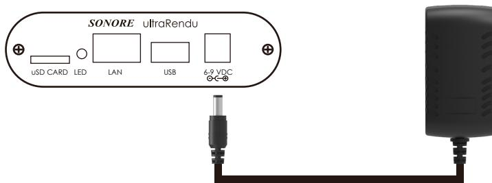
ultraRenduのDC電源コネクタに付属のiFi audio iPower 9VのDCプラグを挿し込み、iPower 9Vを壁コンセントや電源タップに接続ください。また、ultraRenduは6V-9VDCに対応しているため、当電圧範囲内のDC電源をお使いいただくこともできます。
