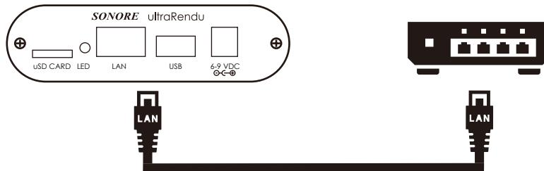
ultraRenduのLANコネクタとスイッチングハブやルーターのLANコネクタをLANケーブルで接続ください。このとき、ultraRenduが接続されるネットワーク環境は、DHCPによるIPアドレス振り出しに対応している必要があります。
