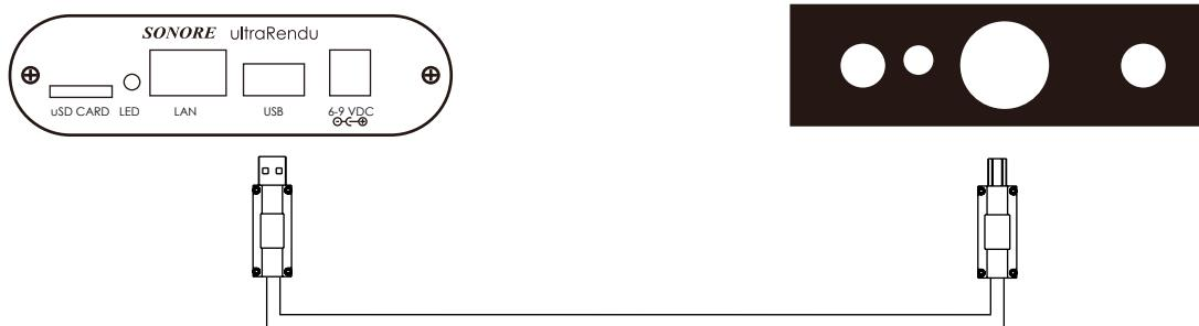
ultraRenduのUSBコネクタとUSB-DACのUSBコネクタをUSBケーブルで接続ください。このとき、USB-DACはUSB Audio Class2.0準拠の必要があります。また、接続後にUSB-DACの電源を入れ、起動後に2)へお進みください。
