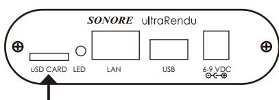
新しいメジャーバージョンのソフトウェアが書き込まれたmicro SDカードを挿入します。メジャーアップデートでは設定が初期化されますので、第3章. 接続手順並びに初期セットアップに従い、接続、初期セットアップを行ってください。
