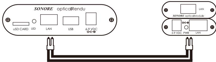
opticalRendu DeluxeのSFPモジュールとスイッキングハブやルーター、opticalModule Deluxe V3などのSFPモジュールを光ファイバで接続ください。光ファイバのキャップを取り外し、opticalModuleに接続します。光ファイバとSFPモジュールの切り欠きの向きを合わせてカチッと音がするまで挿入ください。また光ファイバのキャップは、今後光ファイバを取り外して保管する際に必要となりますので保管ください。このとき、opticalRendu Deluxeが接続されるネットワーク環境は、DHCPによるIPアドレス振り出しに対応している必要があります。
