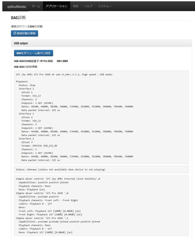
接続したUSB-DACのSonicorbiter OSの認識状況を表示します。対応サンプリングレート、対応フォーマットが確認できます。Native DSD出力に対応しているかどうかの識別は「第8章. Native DSD出力の対応」をご参照ください。
