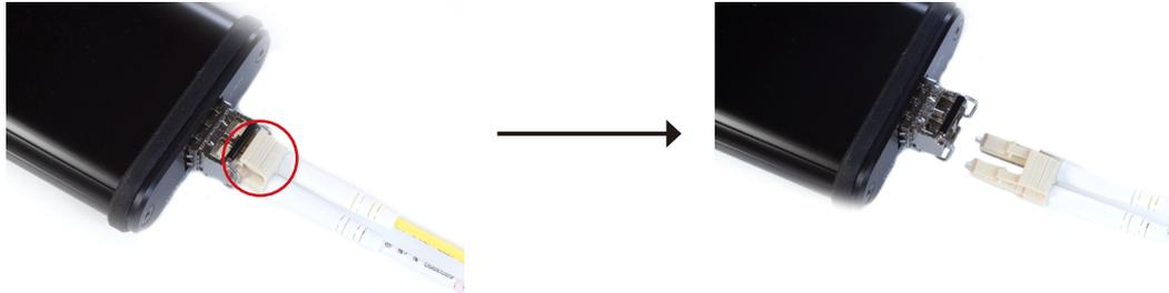
SFPモジュールのラッチを引き起こし、SFPモジュール本体をもって引き抜きます。このときに、opticalRenduの電源をオフにして間もないとSFPモジュールが熱を持っている場合がございますのでご注意ください。
