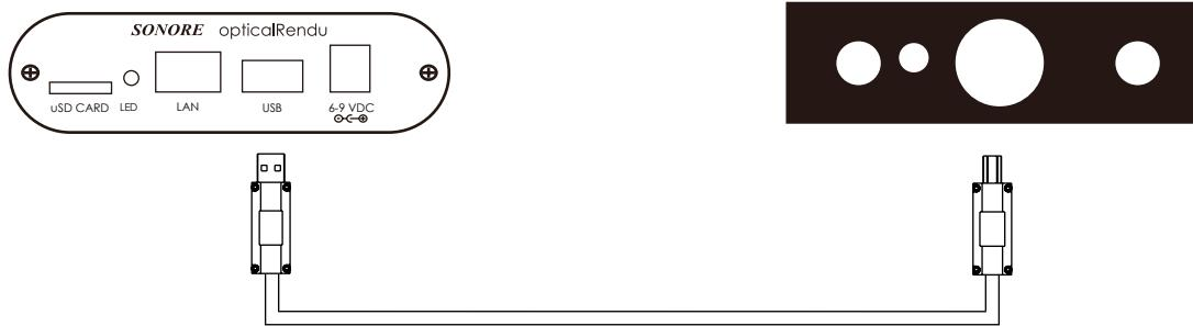
opticalRenduのUSBコネクタとUSB-DACのUSBコネクタをUSBケーブルで接続ください。このとき、USB-DACはUSB Audio Class2.0準拠の必要があります。また、接続後にUSB-DACの電源を入れ、起動後に2)へお進みください。
