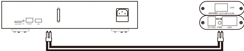
Signature Rendu SE opticalのSFPモジュール(DLC、マルチモード)とスイッチングハブやルーター、opticalModuleなどのSFPモジュールを光ファイバで接続ください。光ファイバのキャップを取り外し、opticalModuleに接続します。光ファイバとSFPモジュールの切り欠きの向きを合わせてカチッと音がするまで挿入ください。また光ファイバのキャップは、今後光ファイバを取り外して保管する際に必要となりますので保管ください。
