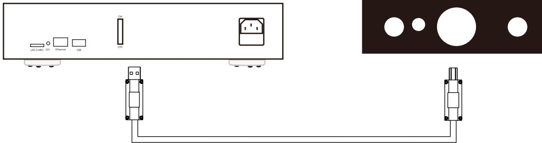
Signature Rendu SE opticalのUSBコネクタとUSB-DACのUSBコネクタをUSBケーブルで接続ください。このとき、USB-DACはUSB Audio Class2.0準拠の必要があります。また、接続後にUSB-DACの電源を入れ、起動後に2)へお進みください。Signature Rendu SE opticalは付属のSFPモジュールを使い分けることにより、光LAN接続と従来のLANケーブル接続のどちらも使用可能です。SFPモジュールの挿抜方法は第10章、光ケーブルとSFPモジュールの取り外しをご参照ください。また、Signature Rendu SE opticalが接続されるネットワーク環境は、DHCPによるIPアドレス振り出しに対応している必要があります。
