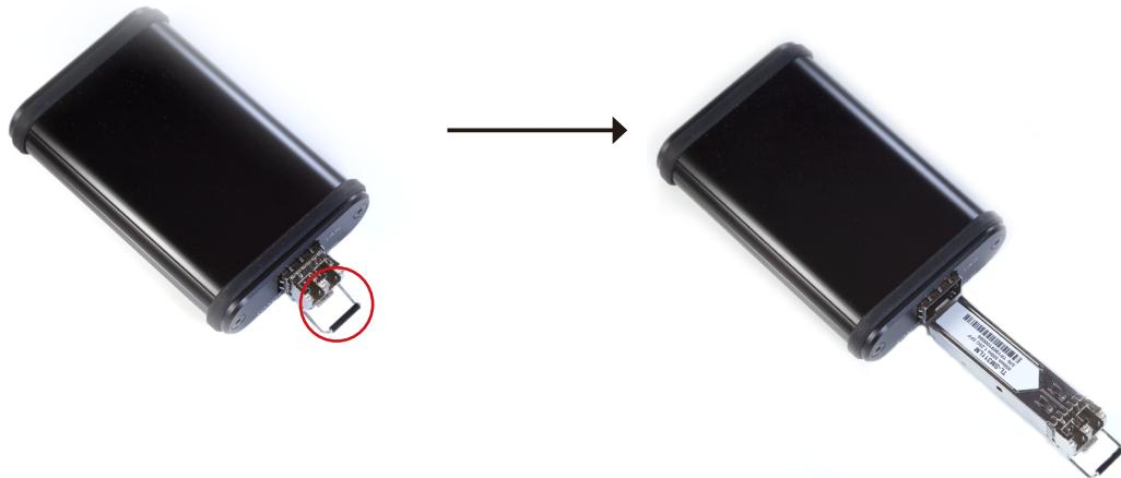
SFPモジュール、光ファイバを取り付ける場合には、上記手順を逆順で行ってください。SFPモジュール、光ファイバは十分に挿入されるとカチッと音がします。
