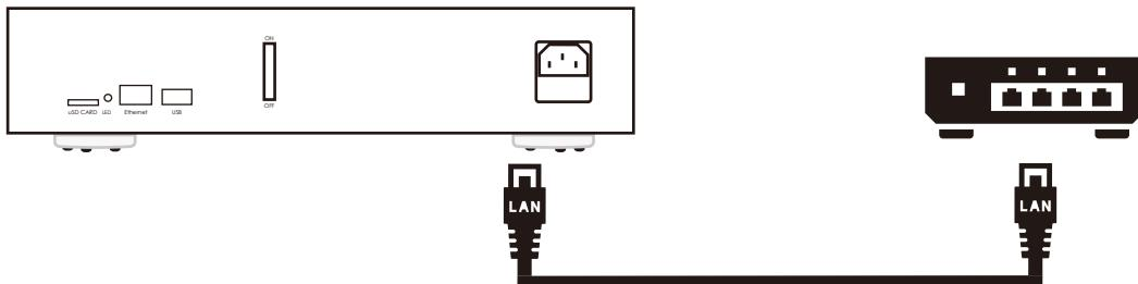
Signature Rendu SE opticalのSFPモジュール(RJ45)とスイッチングハブ等の機器をLANケーブルで接続します。
