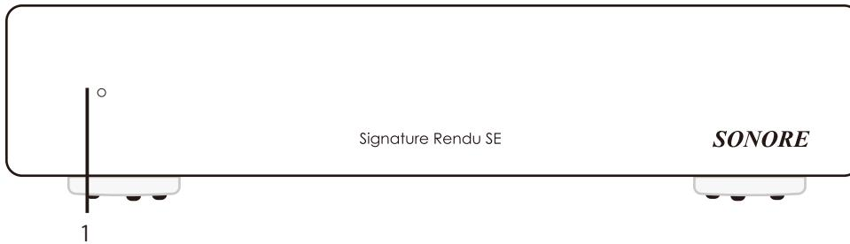
1)電源LED：電源オン時に白く点灯します
