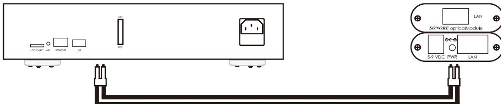
Signature Rendu SE optical DeluxeのSFPモジュール(DLC、マルチモード)とスイッティングハブやルーター、opticalModule Deluxe V3などのSFPモジュールを光ファイバで接続ください。光ファイバのキャップを取り外し、opticalModuleに接続します。光ファイバとSFPモジュールの切り欠きの向きを合わせてカチッと音がするまで挿入ください。また光ファイバのキャップは、今後光ファイバを取り外して保管する際に必要となりますので保管ください。
