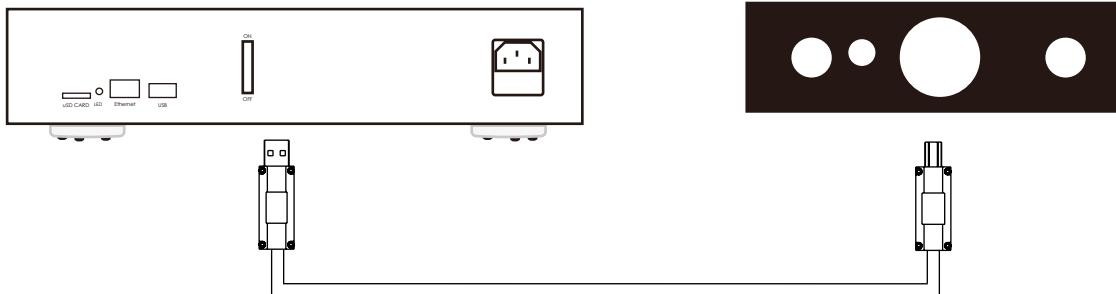
Signature Rendu SE optical DeluxeのUSBコネクタとUSB-DACのUSBコネクタをUSBケーブルで接続ください。このとき、USB-DACはUSB Audio Class2.0準拠の必要があります。また、接続後にUSB-DACの電源を入れ、起動後に2)へお進みください。Signature Rendu SE optical Deluxeは付属のSFPモジュールにより、光LAN接続が使用可能です。SFPモジュールの挿抜方法は第10章. 光ケーブルとSFPモジュールの取り外しをご参照ください。また、Signature Rendu SE optical Deluxeが接続されるネットワーク環境は、DHCPによるIPアドレス振り出しに対応している必要があります。
